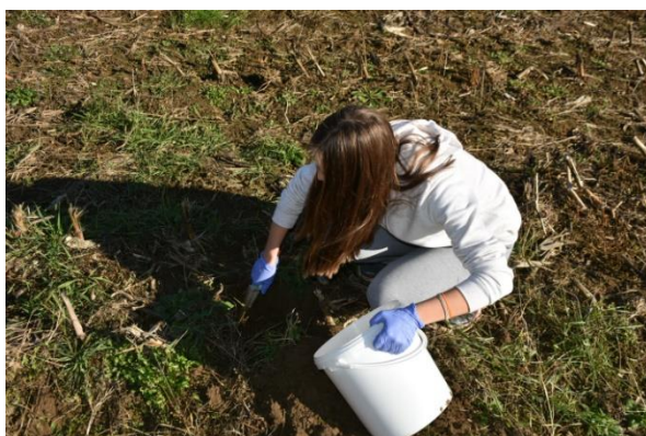
Slika 1: Primer odvzema enega delnega vzorca tal.
